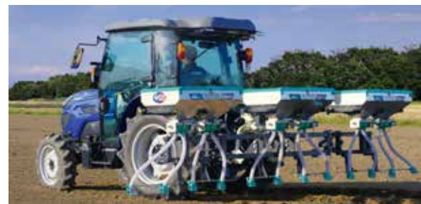
直進アシストトラクタと高精度ソワー
