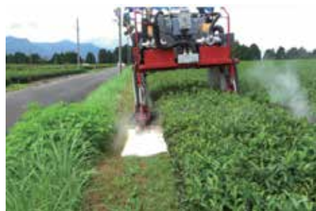
蒸気を畝間に吹き付け
