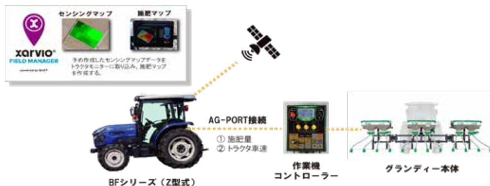
直進アシストトラクタと高精度ソワー
