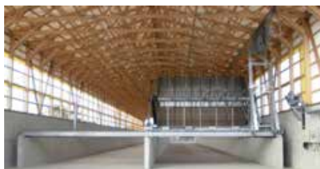
トラバーサー式ロータリー 発酵機
