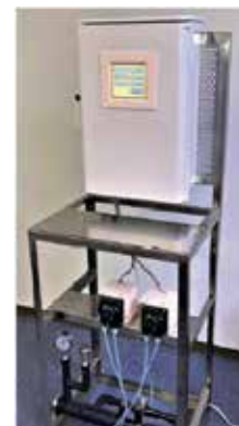
養液土耕栽培システム (液肥混入機)
