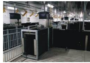
図 豚の体重と飼料摂取量を計測するパフォーマンススター
