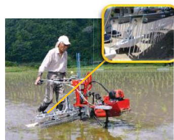
「揺動ブラシ式歩行型除草機」と除草機構「揺動ブラシ」の拡大図
