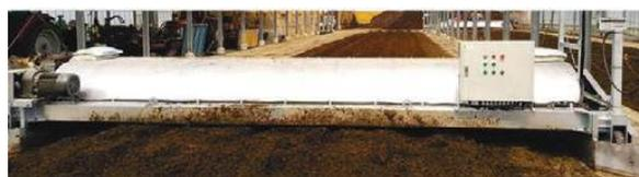
基礎なしロータリー式攪拌機
