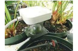
検証中の葉面積評価センサ(実用機)
