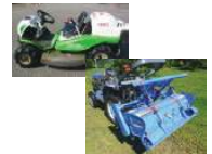
粉碎後に中耕すき込み処理 時速3kmで粉碎後、時速2~2.5kmで中耕(30分/10a→45~60分/10a)。各1回ずつ
