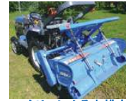
ロータリーによる中耕すき込み処理 時速1km以下(1時間45分/10a)で1回
