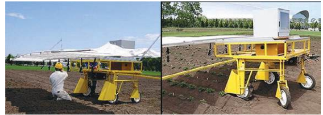
自動検出プログラムを搭載したほ場管理車両(異常株検出支援システム)
