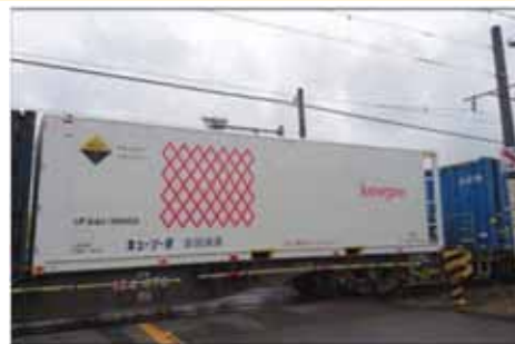
31ft 鉄道冷凍コンテナの様子
