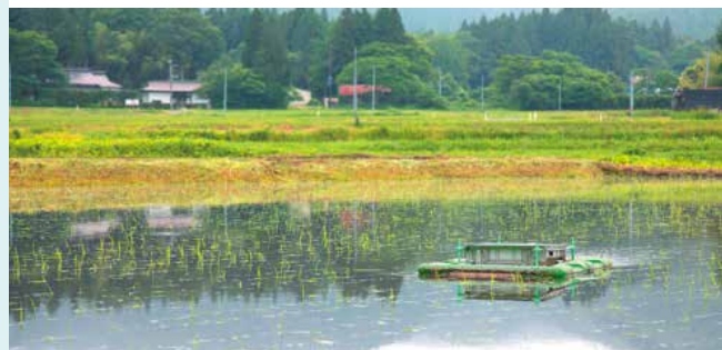
① アイガモロボット 泥を巻き上げて、草の発生を抑制するロボット
