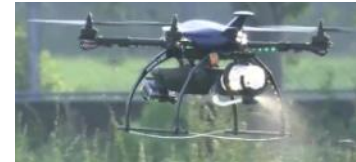
自動飛行で害虫ポイントに到着し、ピンポイント農薬散布
