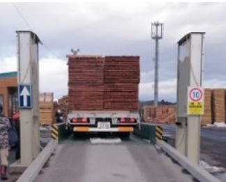
トラックスケール用 検知装置
