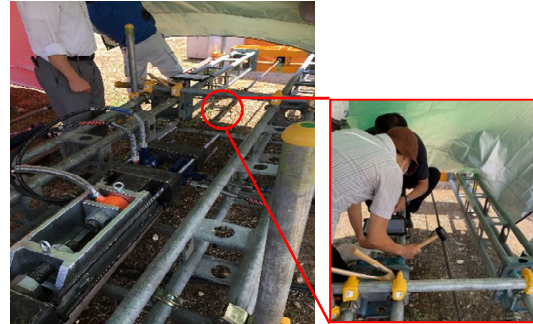
写真-1 室内試験（ケーブル緊張力確認試験）
