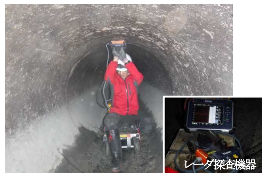
写真-9 電磁波レーダ探査法による調査実施状況
