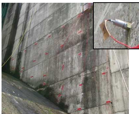
写真－1 調査範囲の受信センサー配置状況
