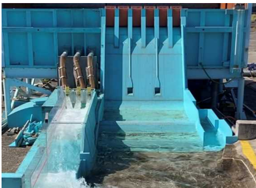
写真-1 水理模型実験 (全体模型)
