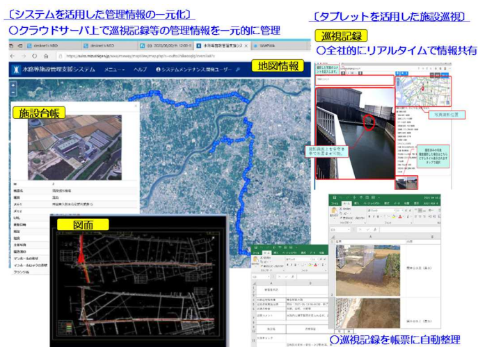
図－4 水路等施設管理支援システム（左図）及びシステムを活用した巡視点検・訓練状況（右図）
