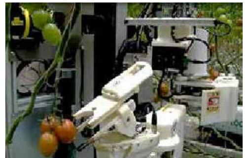
図1 自動的にトマトを収穫するロボット
