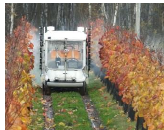
車載カメラ画像のAI解析による 植物密度に応じた可変防除
