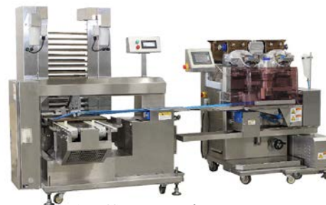
包餡機とセットパンナー （米粉パン生地を形を整えて分割し、整列させる）
