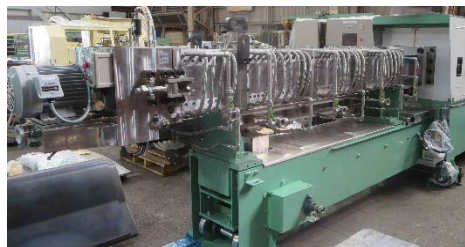
エクストルーダー （1台の機械で短時間に原料米をアルファ化処理する）
