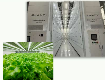
株式会社プランテックス 世界初の完全密閉型植物工場技術「Culture Machine」により、精密制御された環境下でレタスやハーブ等を生産。
