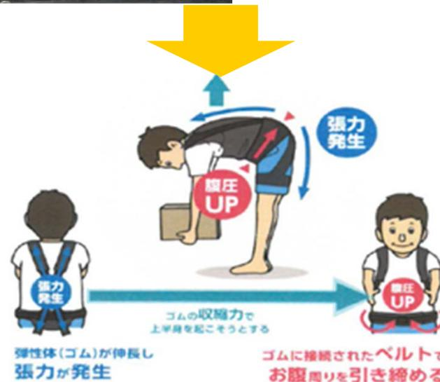
養殖コンテナを筏上に、1日数十回繰り返して行うなど、養殖漁業者は重労働を余儀なくされています。このため、弾性体(ゴム)の張力で省力化効果を生じさせるスマートスーツを開発しました。
