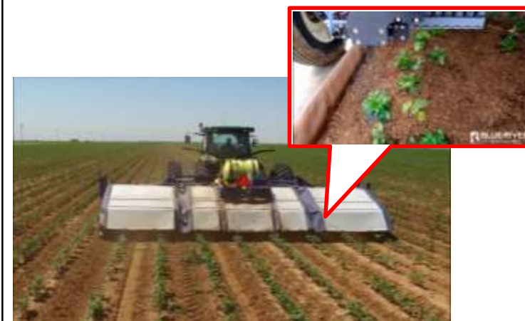
＜ジョンディア社（Blue River Technology）提供＞ 除草剤散布ロボット「See & Spray」
