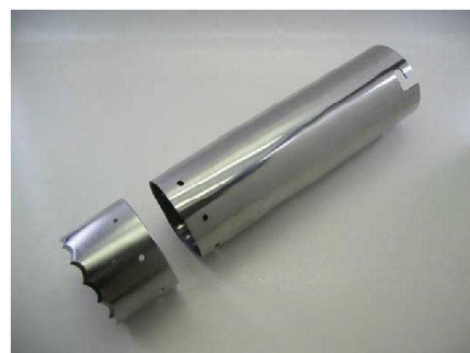
写真1. フィードサンプラーの刃先と円筒
