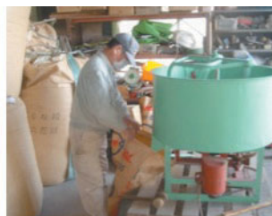
小ロットの自家配合飼料製造状況。粉米や米ぬか等の単味飼料原料投入後攪拌。
