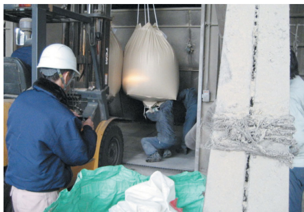
粉碎ホッパー投入作業状況
