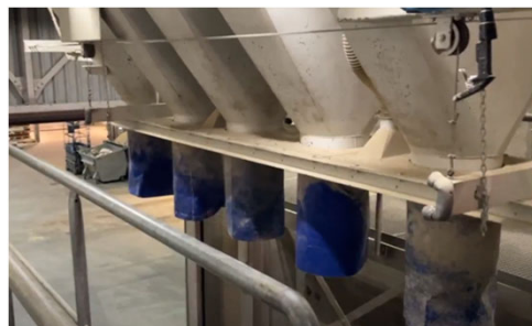
飼料タンクの排出口が蛇腹のようになっている配合飼料製造工場（左）、一般の配合飼料製造工場（右）
