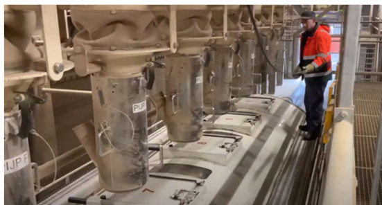
飼料タンクの排出口が蛇腹のようになっている配合飼料製造工場（左）、一般の配合飼料製造工場（右）
