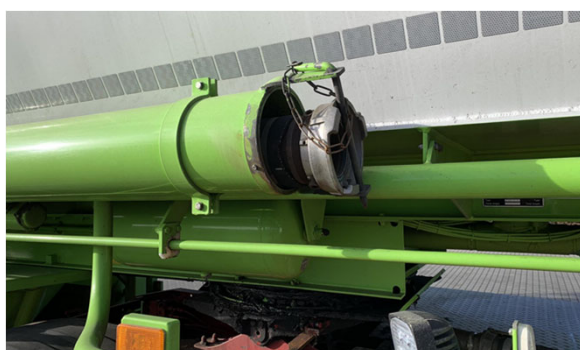
バルク車の飼料搬出用コンプレッサー（左）とゴムチューブ（右）
