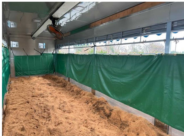
図16 横タレシート設置車内
