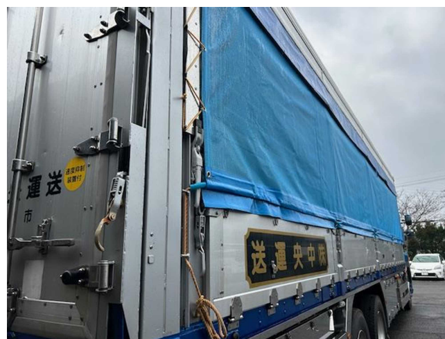
図18 横タレシート設置車内
