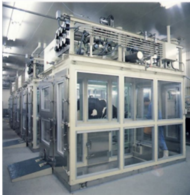
農研機構にある、国内唯一の牛用の生体ガス精密測定装置
