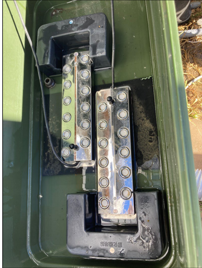
装置内部の超音波素子
