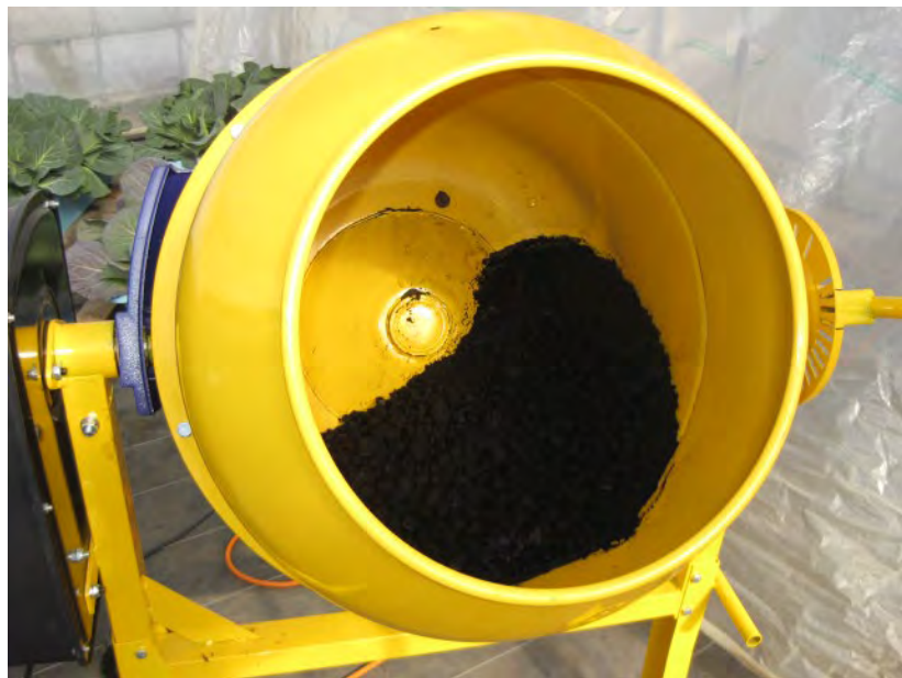
ミキサーを使った簡易型の堆肥成型機 肥料成分を制御した堆肥の製造（LEIO）
