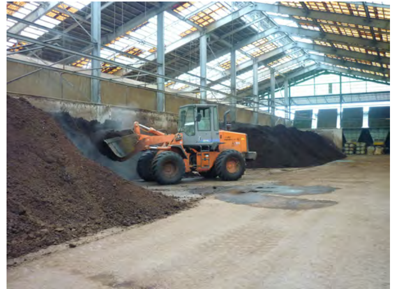
ローダによる切り返し(アーティキュレート)
