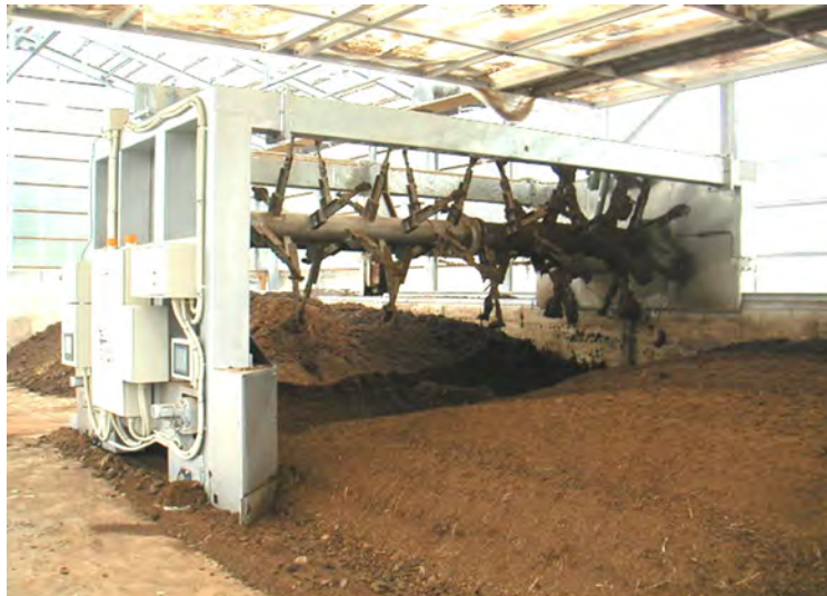
ロータリ式攪拌機による切り返し
