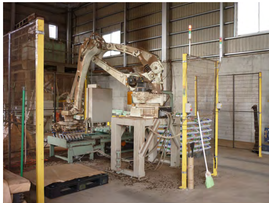
袋詰め装置に隣接した袋積みロボット
