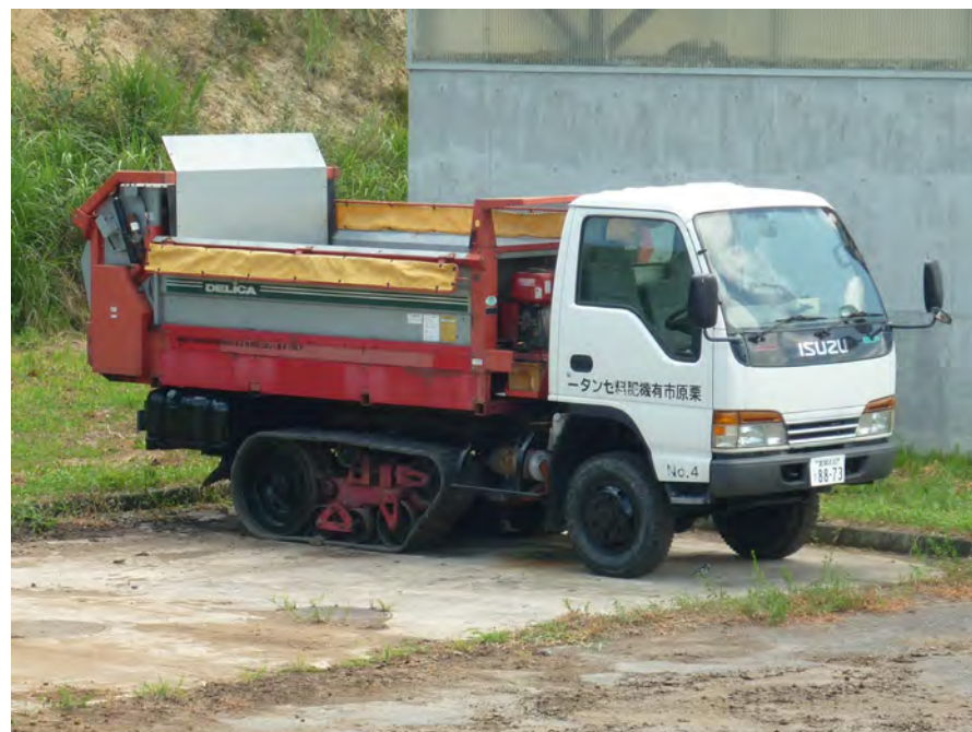
一般道路も走ることの出来る移動と堆肥散布を兼ねた堆肥散布車
