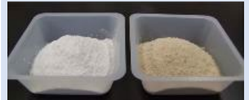
資材（非晶質珪酸カルシウム）と回収品（りん酸肥料として活用）
