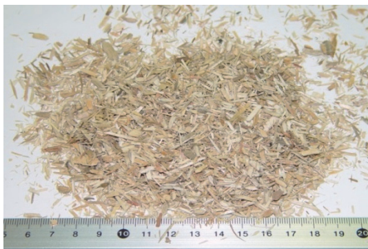
図4 ピンチップ(写真は解体材)
