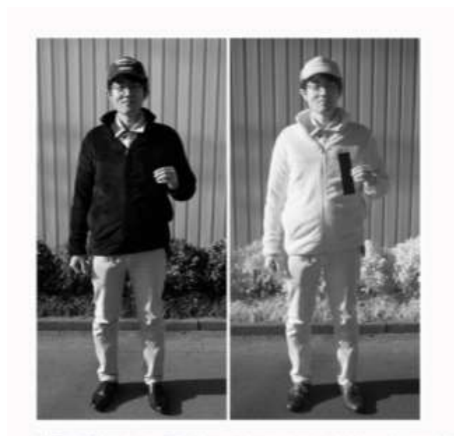
写真 7-11. 近赤外域を吸収する素材（右側写真）の例
