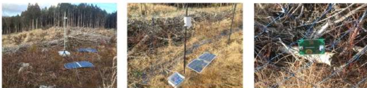
防護柵の破損を検知するための試験
