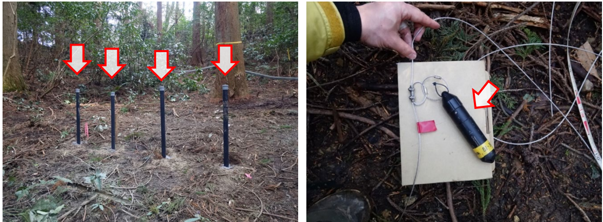
図 VIII-3 (左) 観測井の地上部の様子と (右) 水位センサ
