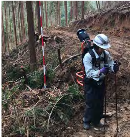
図 4.1 地上 LP データ取得例（左：測定の様子 右：取得した点群の表示例）
