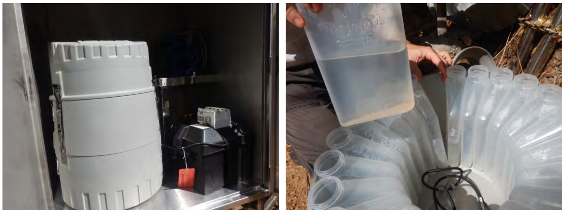
図 4.12 自動採水機(ISCO 社製 SS サンプラー)
