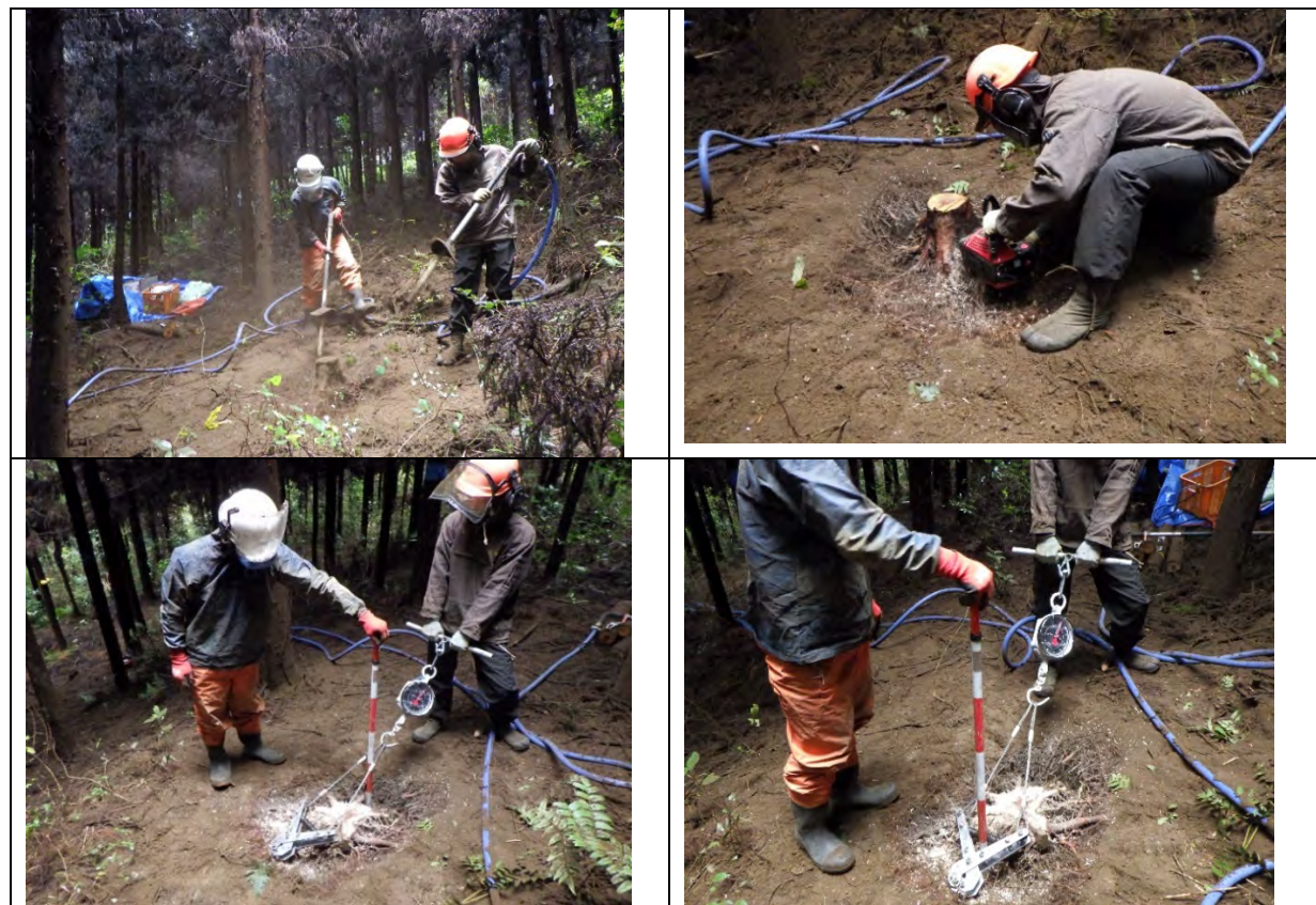
写 2.9 水平根の引き抜き試験
