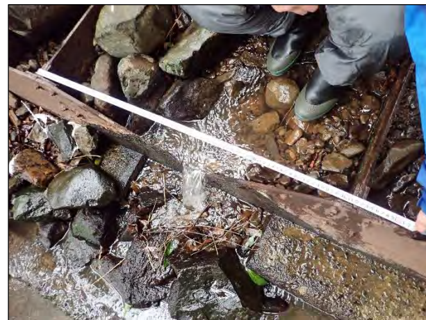
量水のための鋼製三角ノッチ
