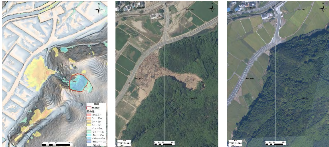
図 4.3.3 差分の原因（災害後の推移状況：新規崩壊地） （左図：差分図、中央：災害後、右図：災害前）＜図郭番号：MD5844＞
