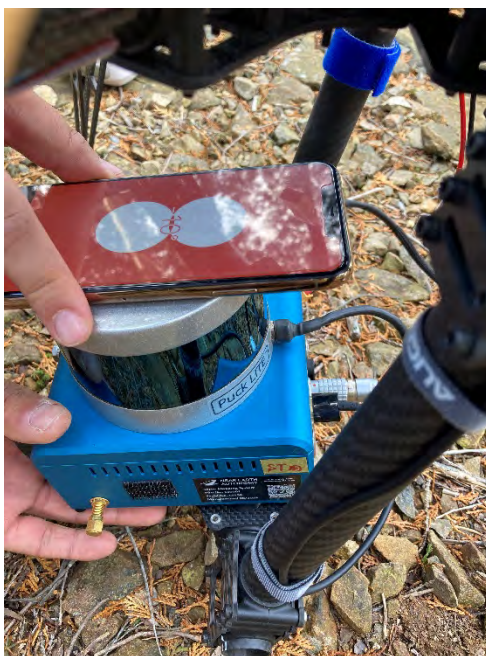
図 2-8 UAV でのレーザ角調整
