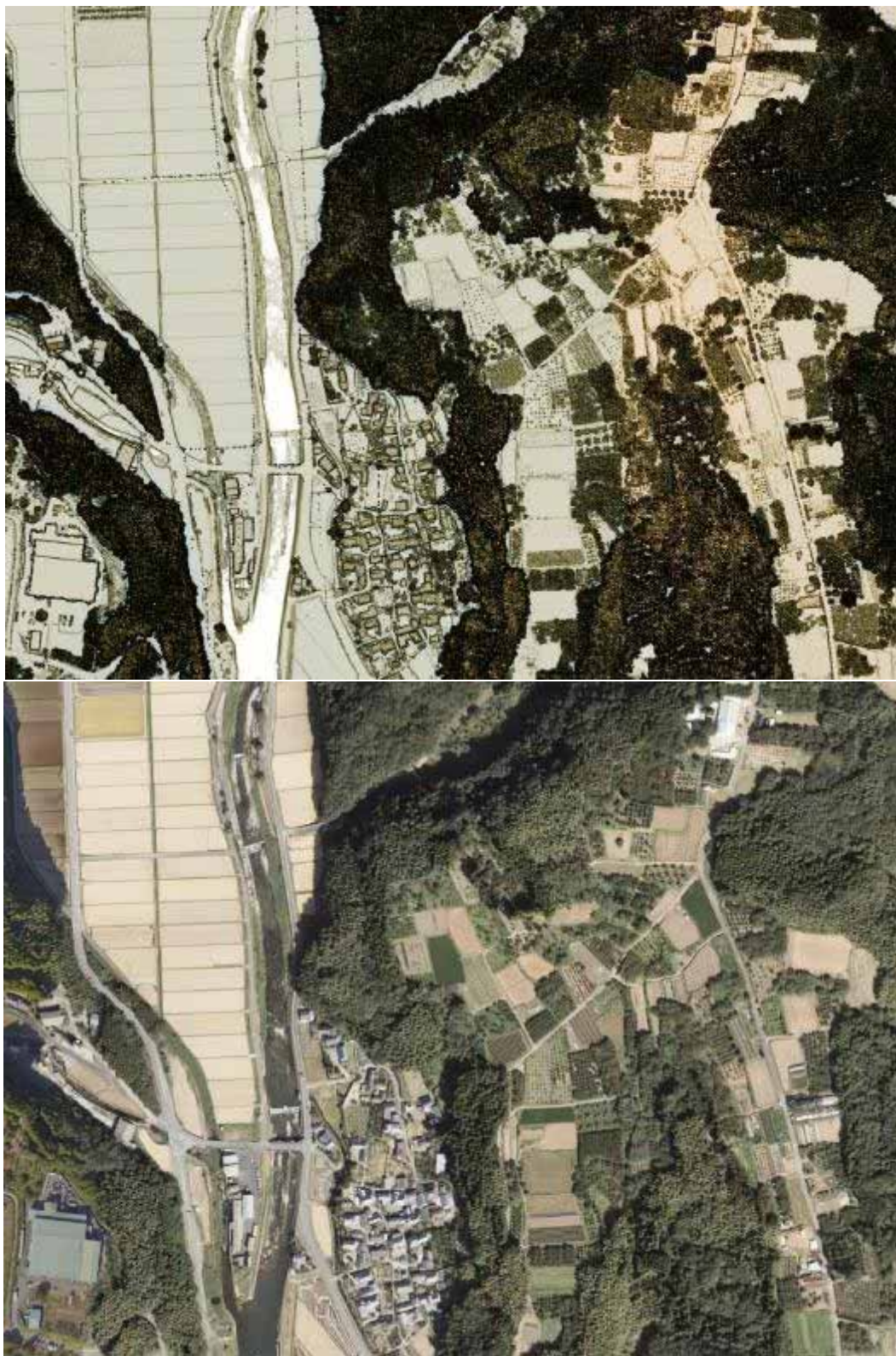
図 2-18 DSM データの陰陽図（上図）と簡易オルソ（下図）（図郭：02JD8432）
