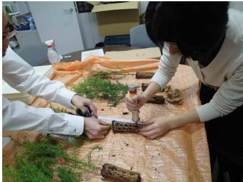
写真 3-1 根鉢の硬度計測の様子
