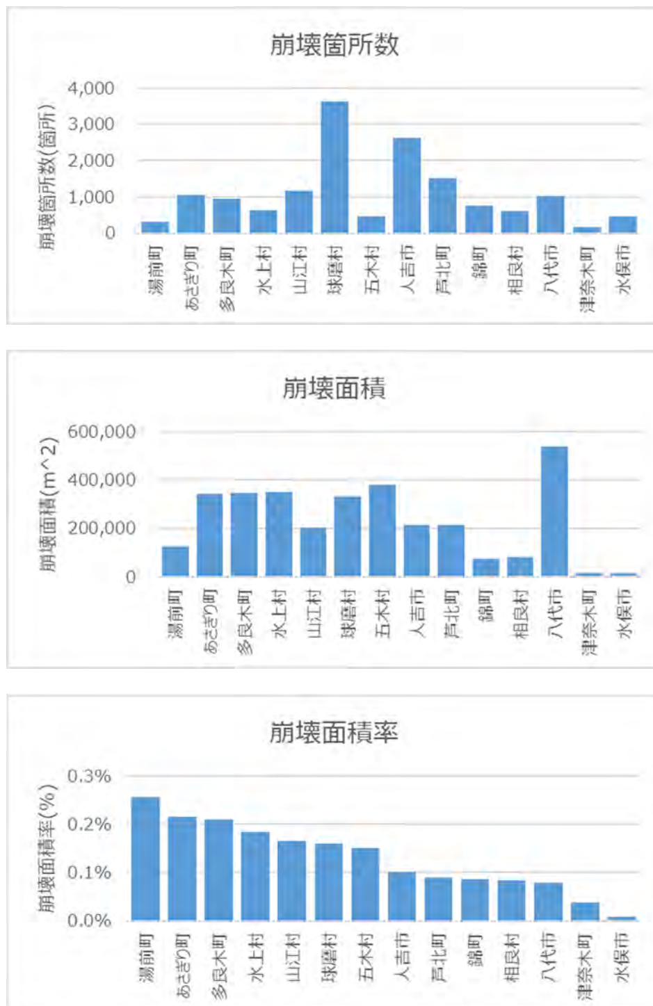
図 4.5.2 市町村ごとの崩壊箇所、崩壊面積および崩壊面積率（グラフ）
