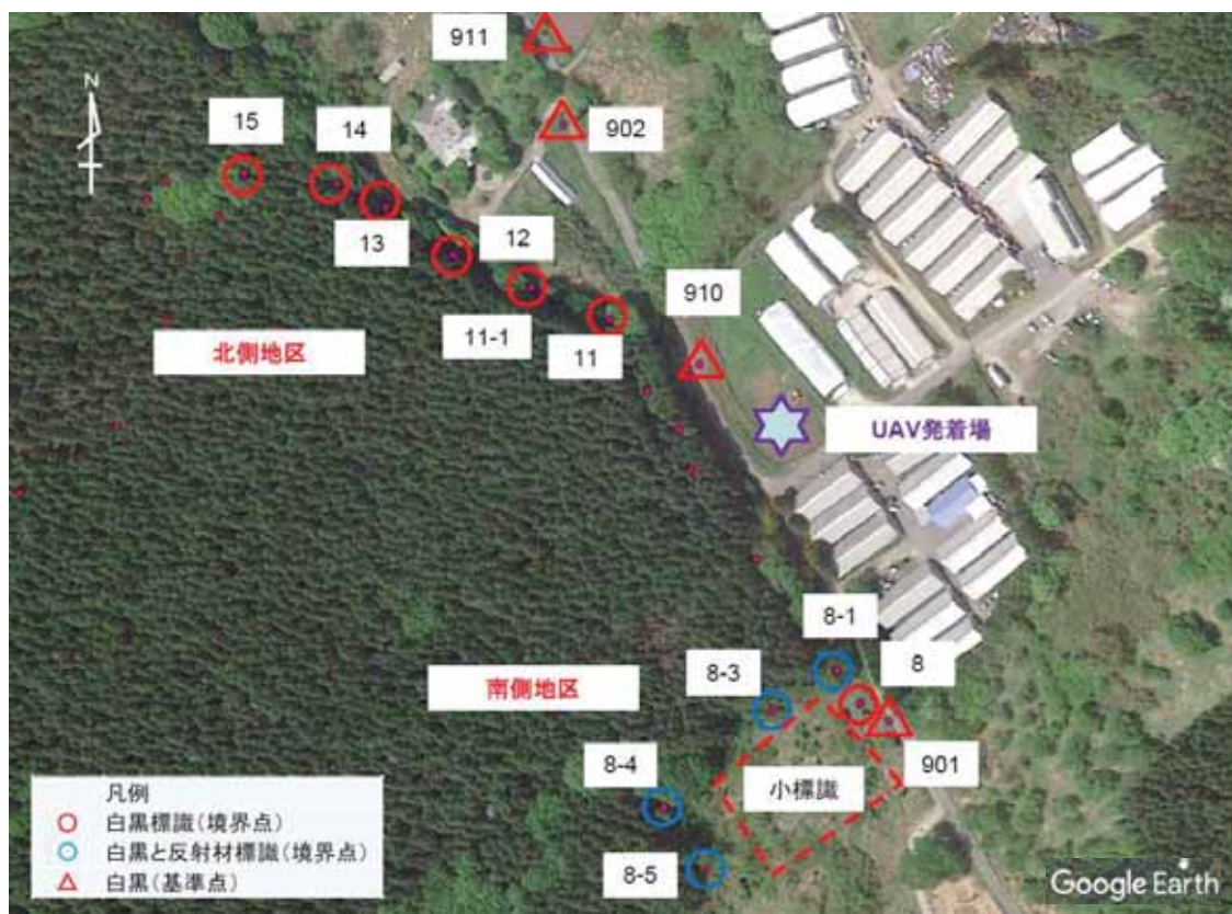
図 3.3-18 対空標識の設置点
