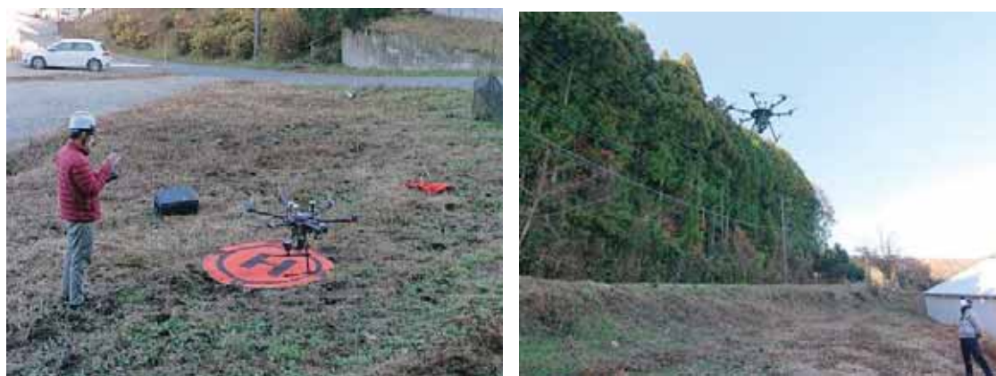
図 3.3-10 UAV レーザスキャナによる計測
