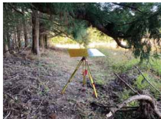
図 3.3-17 対空標識の設置状況 (右側は黄色の反射素材を使用)
