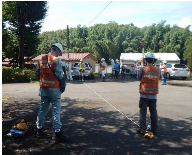
写真 3-4 バーテックスの距離計測精度の確認
