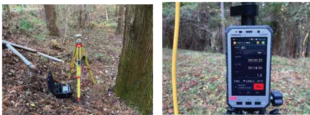
図 3.3-43 ②ネットワーク型 RTK(VRS 方式)
