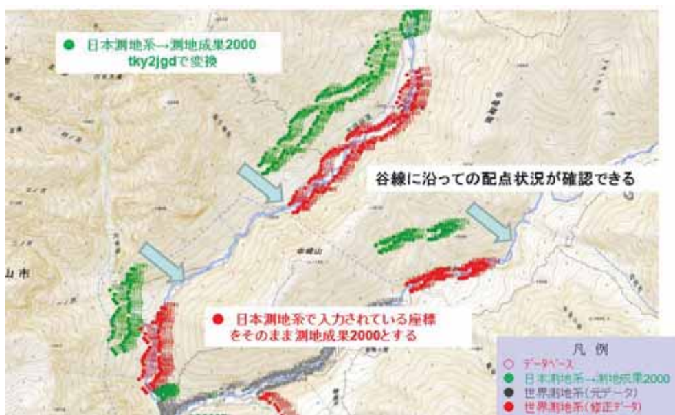
図 4.1-5 誤変換した日本測地系データの表示例（世界測地系データ混入の事例）
