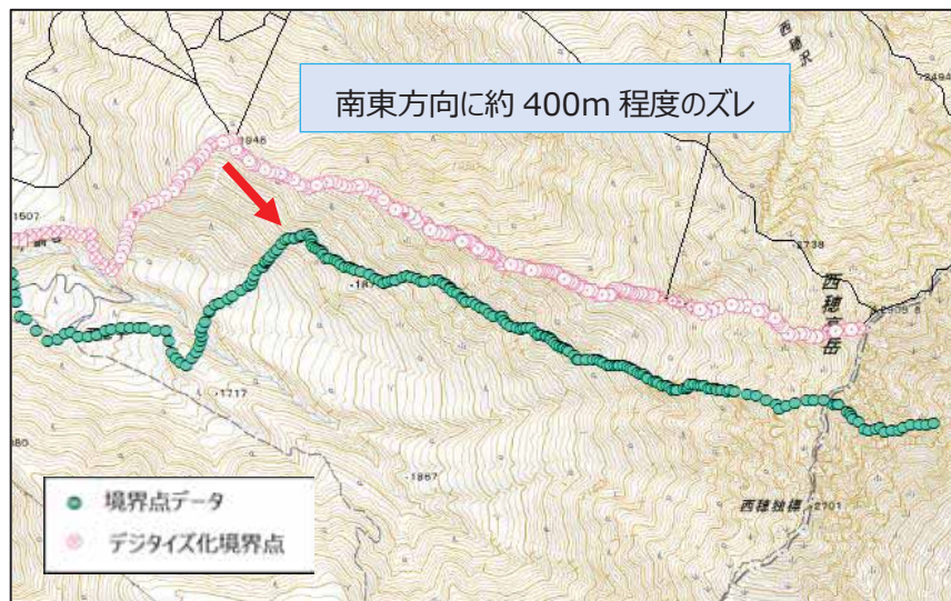
図 4.1-2 日本測地系と世界測地系の取扱い誤差
