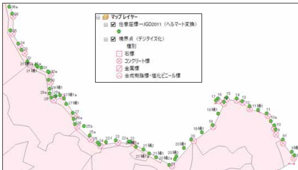
図 3.3-64 ヘルマート変換後の任意座標データと林野庁境界デジタルデータ
