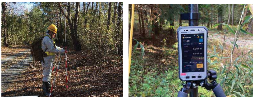
図 3.3-43 ②ネットワーク型 RTK(VRS 方式)
