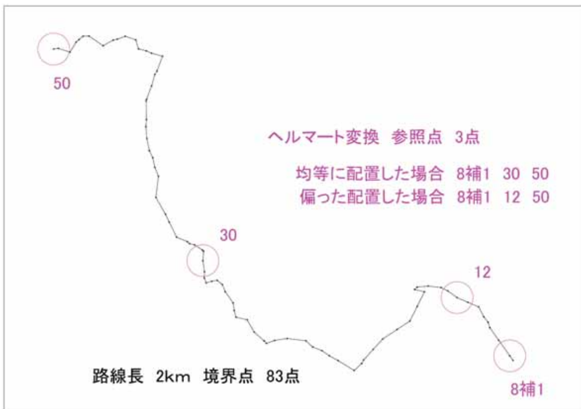
図 3.3-60 ヘルマート変換の参照点の配置
