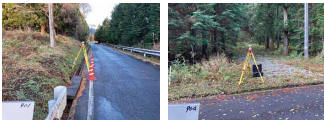
図 3.3-37 GNSS による取付け点の観測（左：起点側、右：終点側）
