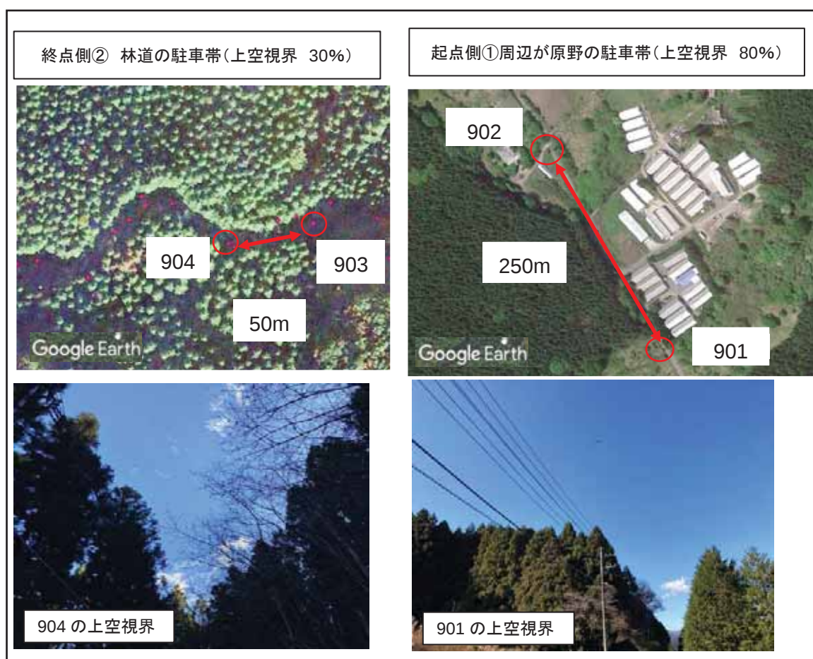
図 3.3-36 GNSS の観測点と上空視界
