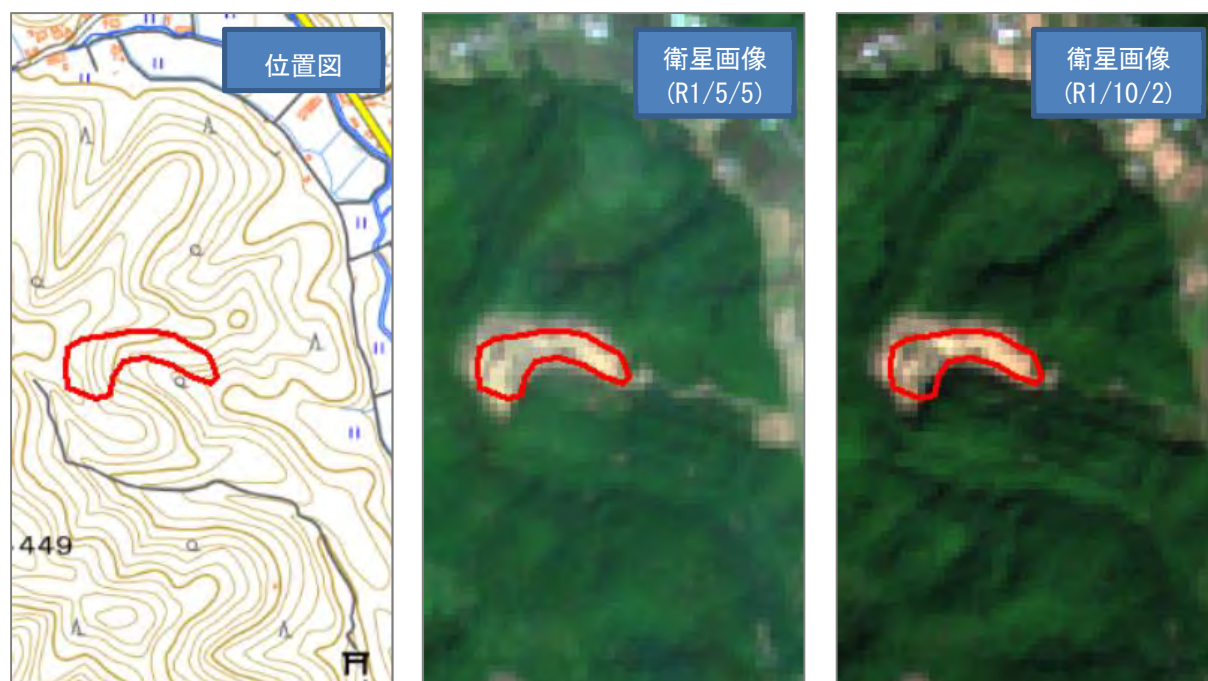
図 2-2 衛星画像を重ね合わせた教師エリアの例（災害前は「植生がない（裸地）」状態）
