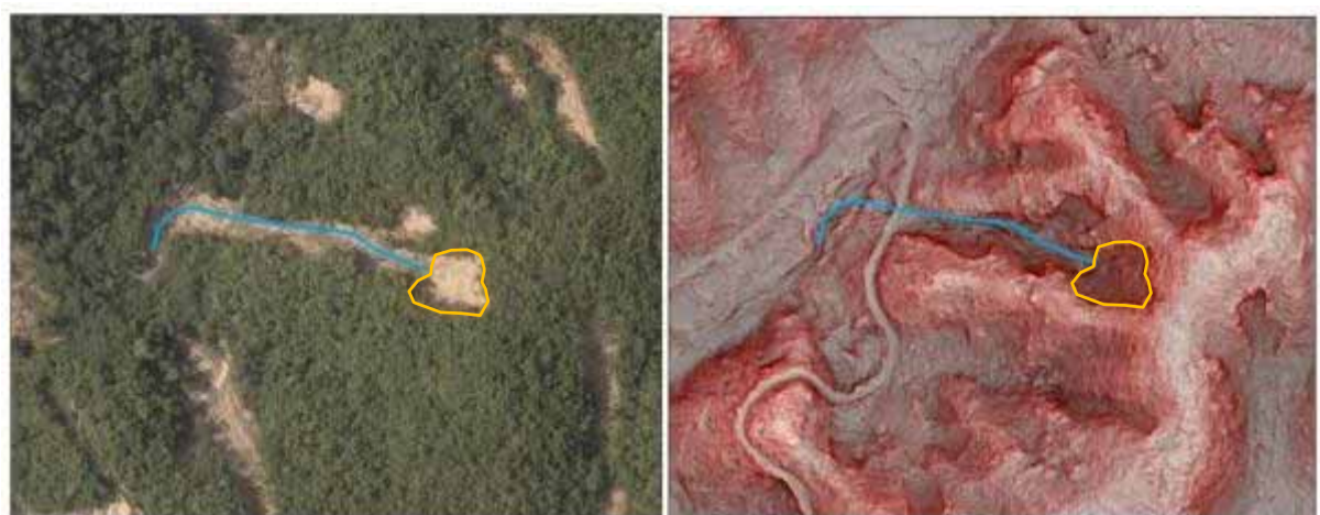
図 3-6 崩壊主部と流下侵食域の判読例
