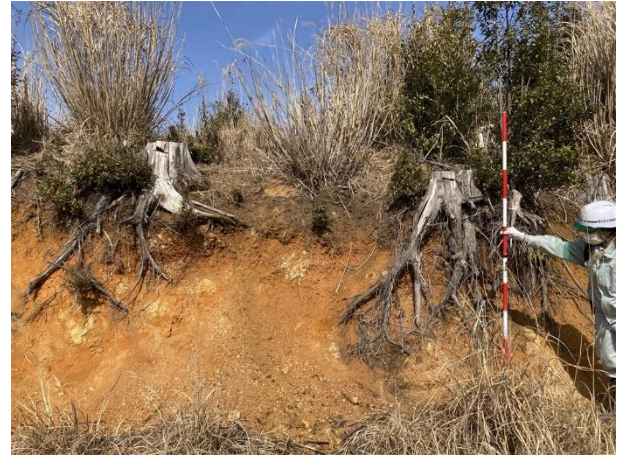
写真 3.10 崩壊面に確認されるパイピング孔と根系の伸長状況
