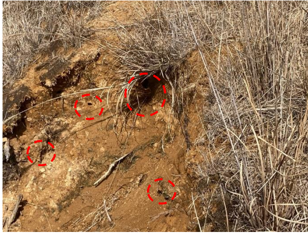
写真 3.10 崩壊面に確認されるパイピング孔と根系の伸長状況
