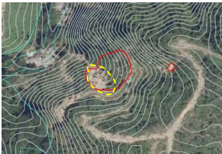
図 4.4 崩壊地範囲の不整合（現地確認崩壊地⑨：図中黄点線が実際の崩壊地）
