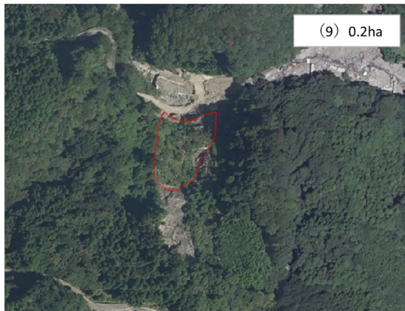
図 4.3 崩壊地データと現地との不整合例
