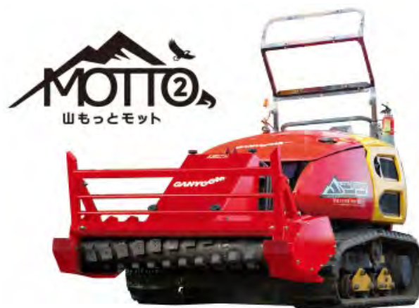
立位乗用型「山もつとモット」（伐根破碎用アタッチメント装着型）（キャニコム社 HP より）
