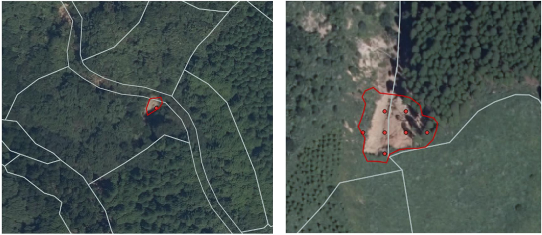
図 1.2 崩壊地ポイントデータ例（左：崩壊地内にポイントが 1 つの例、右：複数の例）
