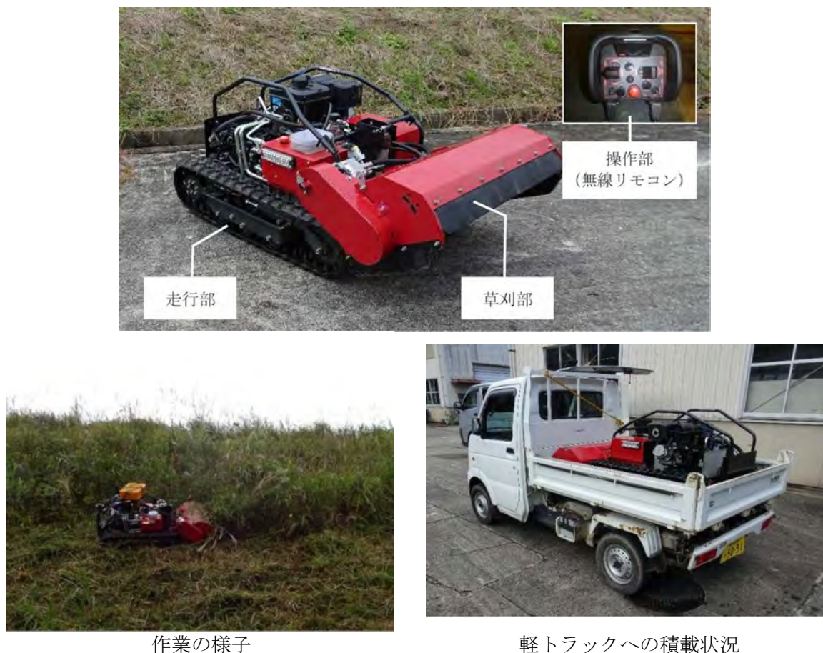
図 7.3 国産初のリモコン式小型ハンマーナイフ草刈機（同コンソーシアム資料より）
